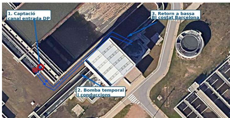
Il·lustració 6. Vista en planta esquema general de la prova
