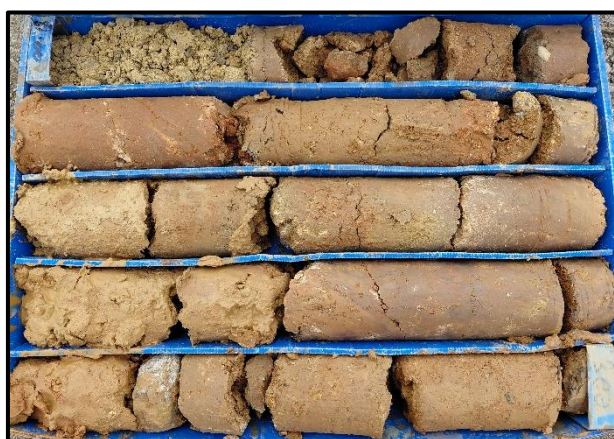
Aspecte dels materials de la capa R, principalment de caràcter cohesiu, amb trams més granulars intercalats i localment amb algun nivell de graves i blocs intercalat.
