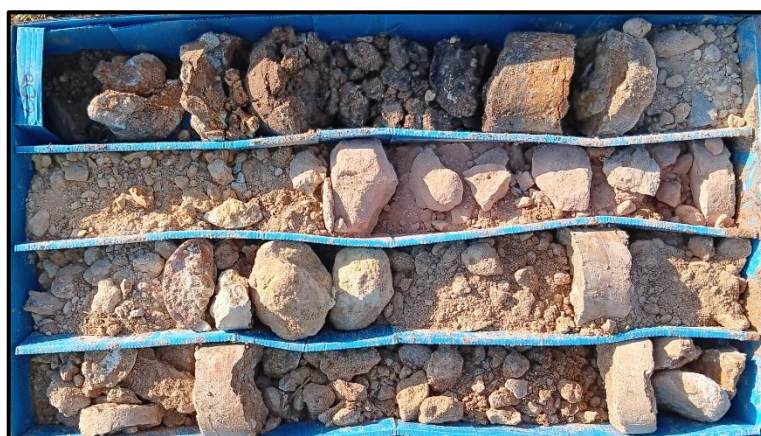
Aspecte dels materials de rebliment que constitueixen la capa R en el sector d'actuació de l'estació de bombament intermedi.
