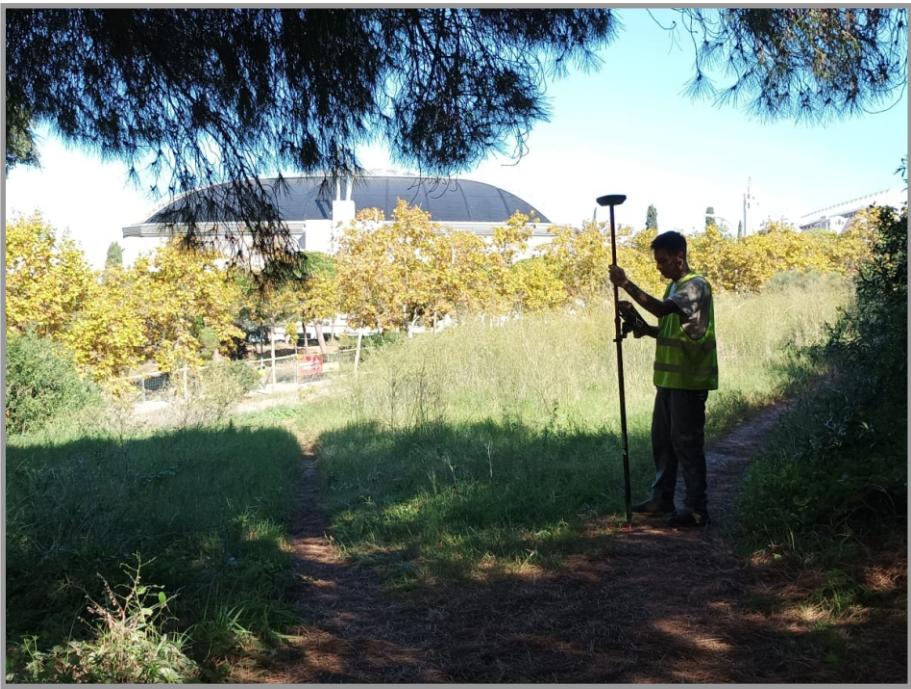
Fotografia 6. Aixecament topogràfic (GPS-RTK) a la Zona3 - Dipòsit Montjuïc.
