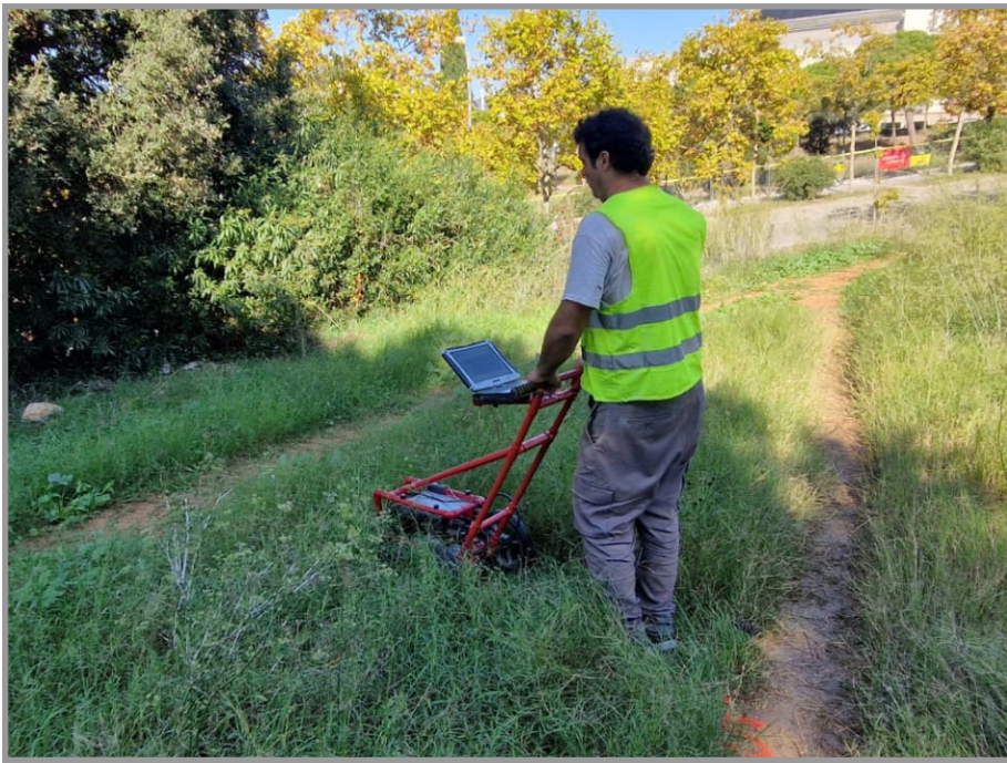
Fotografia 5. Prospecció amb georadar a la Zona3 - Dipòsit Montjuïc.
