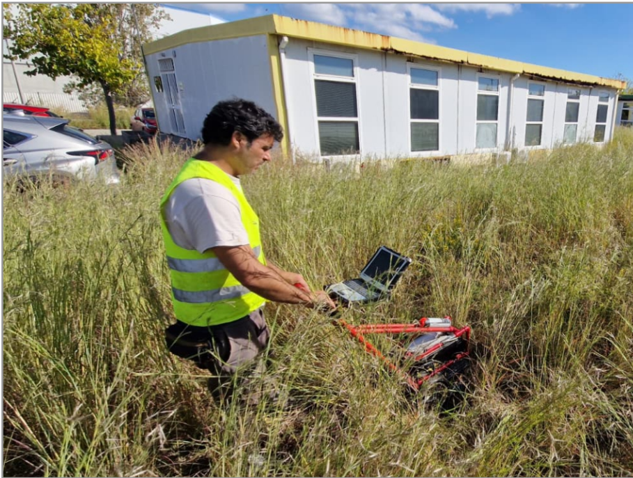
Fotografia 2. Prospecció amb georadar a la Zona1 - Capçalera.
