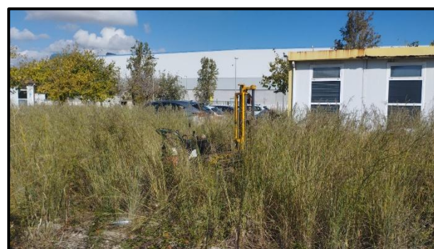
Vistes de la parcel·la d'estudi, on es pot veure l'emplaçament de la sonda efectuant els assaigs de penetració dinàmica tipus DPSH, P-1 i P-2.
