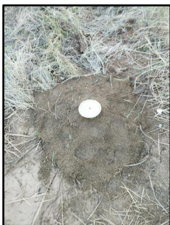
Detall del piezòmetre instal·lat en el punt de sondeig S-2 i durant una de les lectures del nivell freàtic mitjançant sonda piezomètrica manual.
