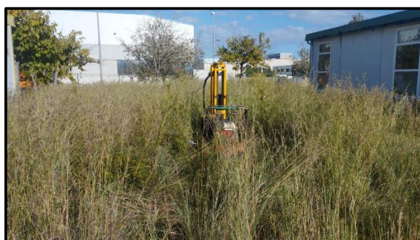
Vistes de la parcel·la d'estudi, on es pot veure l'emplaçament de la sonda efectuant els assaigs de penetració dinàmica tipus DPSH, P-1 i P-2.
