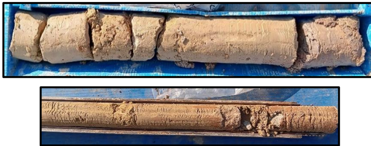
Aspecte dels materials cohesius quaternaris de la capa A. La imatge inferior correspon al material extret a partir d'un assaig SPT.
