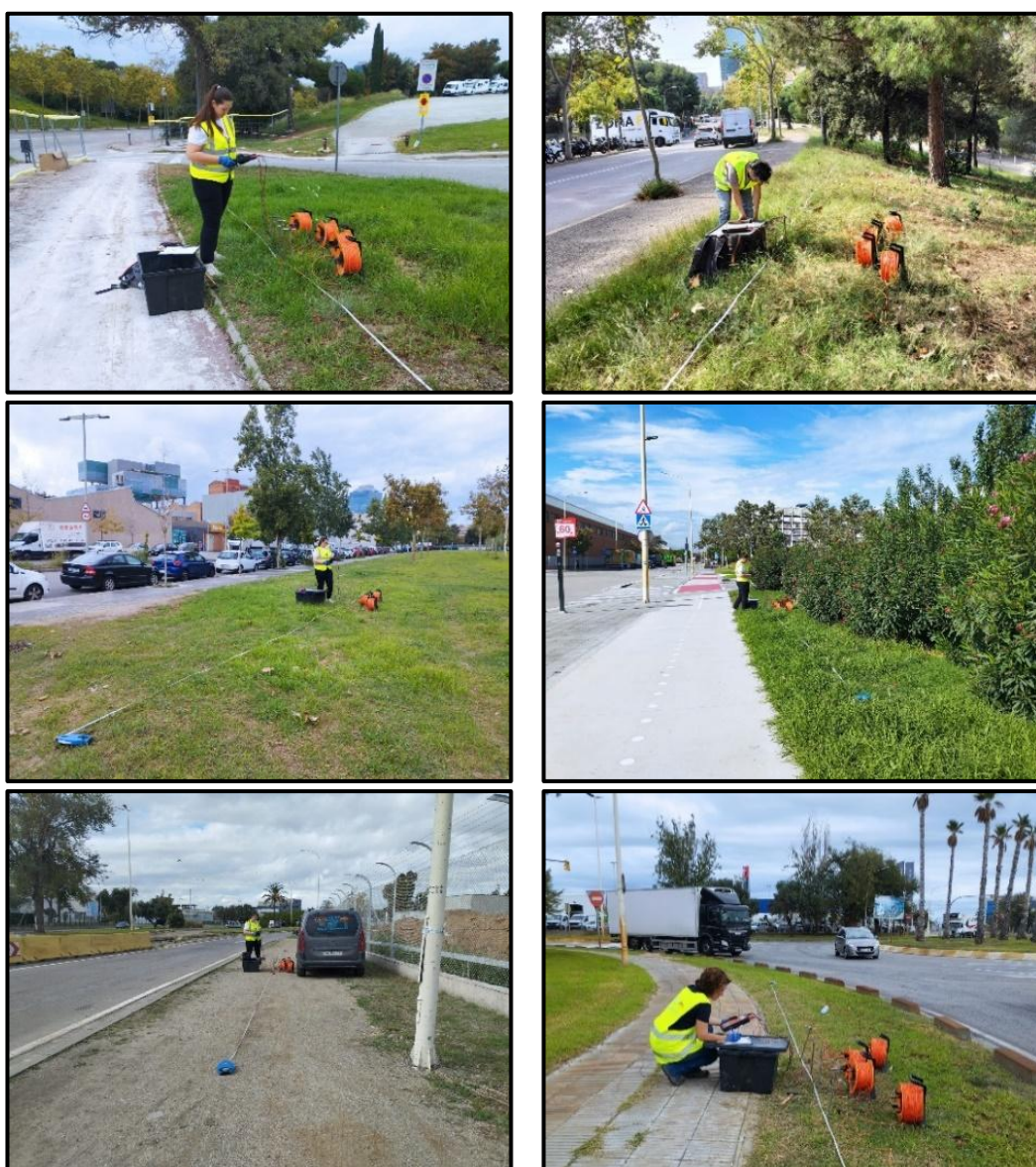
Emplaçament dels SEVs realitzats al llarg de la traça de les noves canonades projectades, corresponents als SEV-1, SEV-2, SEV-3, SEV-4, SEV-5 i SEV-6 vistos d'esquerra a dreta i de dalt a baix.
