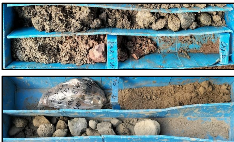
Aspecte dels materials granulars que constitueixen la capa C, amb trams on predominen les graves i trams intercalats més sorrencs.
