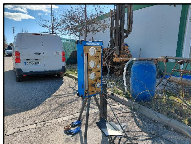
Imatges de la unitat de control durant la realització dels assaigs pressiomètrics efectuats en els sondeigs S-6 i S-7.
