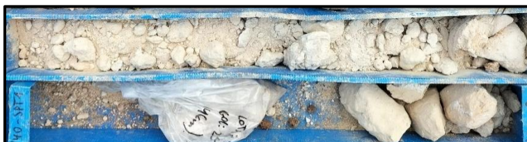
Aspecte dels materials llimosos i carbonatats de la capa A.
