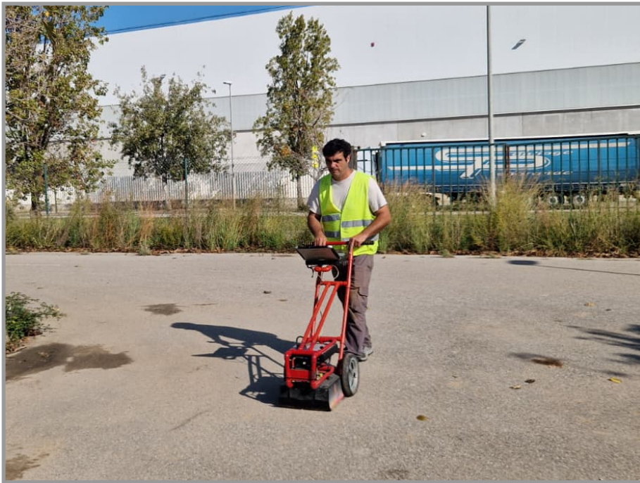
Fotografia 1. Prospecció amb georadar a la Zona1 - Capçalera.
