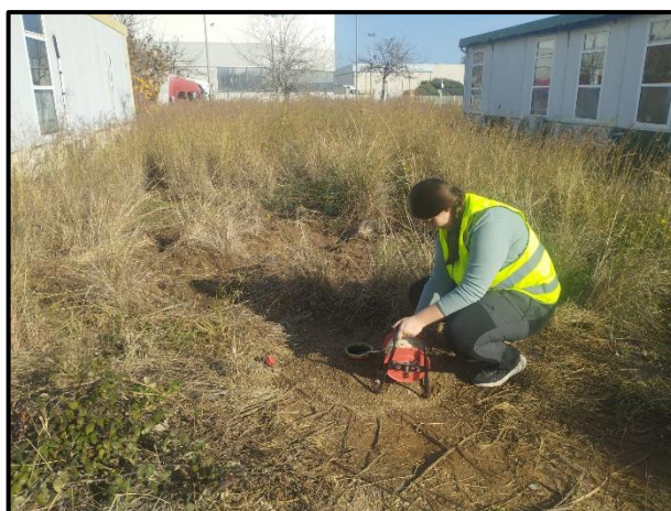
Detall del piezòmetre instal·lat en el punt de sondeig S-2 i durant una de les lectures del nivell freàtic mitjançant sonda piezomètrica manual.
