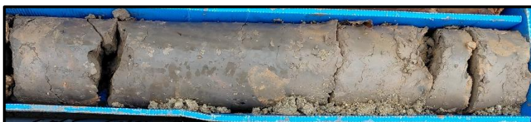
Aspecte del nivell superior cohesiu de la capa A.
