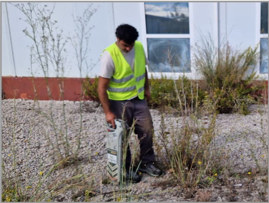
Fotografia 3. Prospecció amb radiodetecció a la Zona1 - Capçalera.
