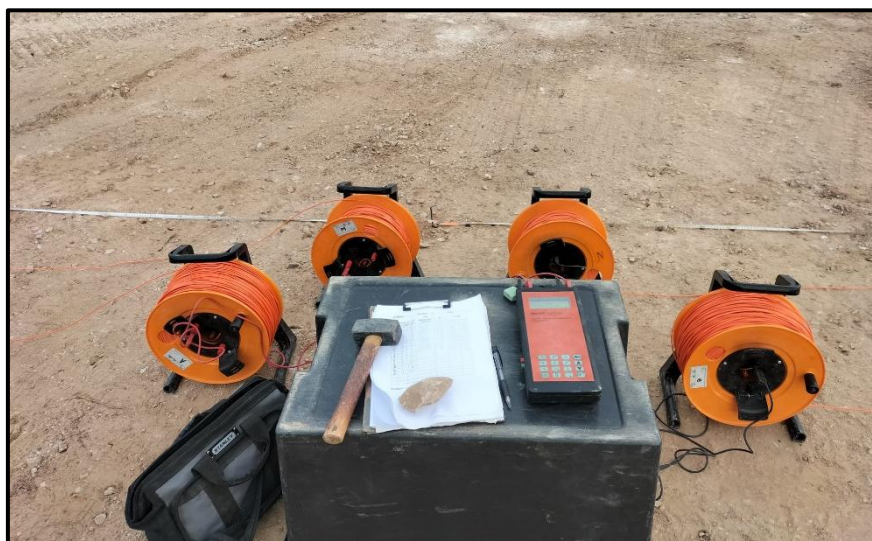
Dispositiu utilitzat per a la realització de la campanya de sondeigs elèctrics verticals (SEV).
