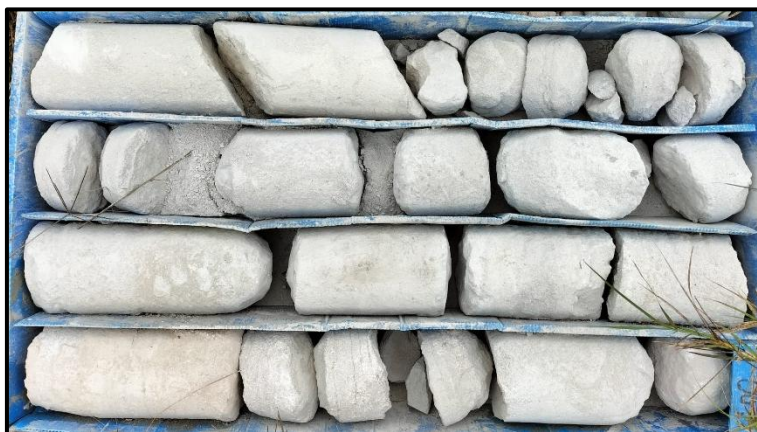
Aspecte de la unitat rocosa de la capa B, d'elevada resistència.
