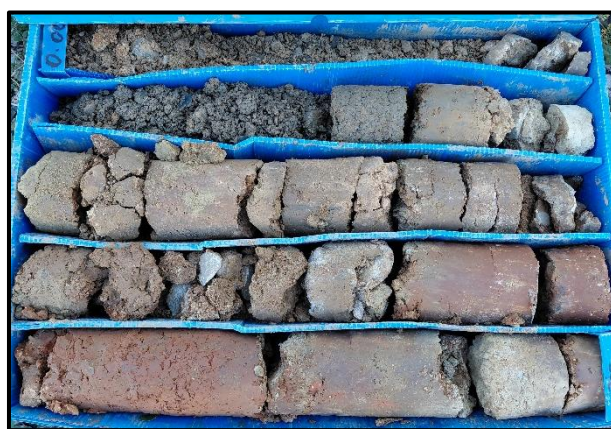
Aspecte dels materials de la capa R, principalment de caràcter cohesiu, amb trams més granulars intercalats i localment amb algun nivell de graves i blocs intercalat.
