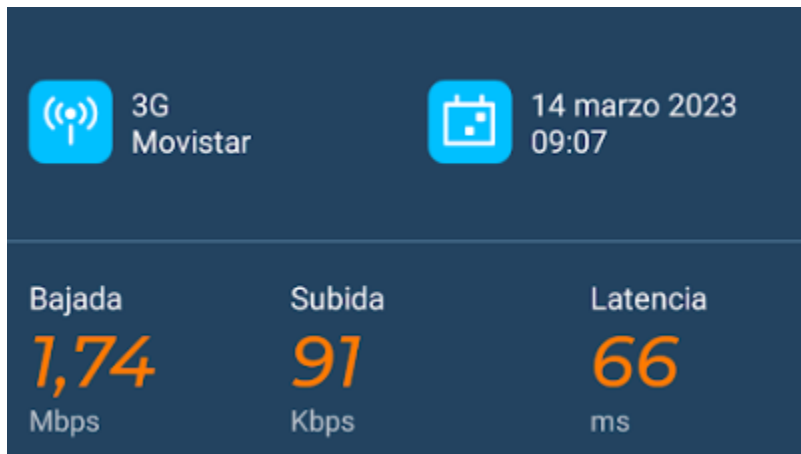
Figura 15. Prueba de cobertura en Pozo 11 (compuerta de chapa cerrada)
