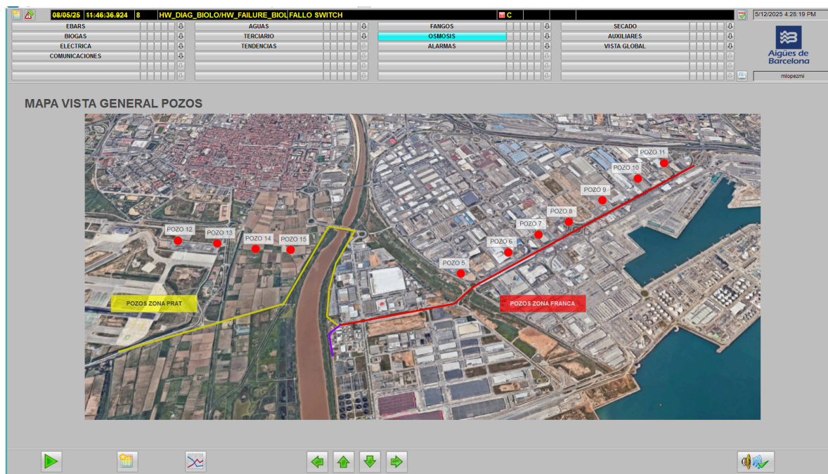
Figura 38. Pantalla "Mapa Vista General Pozos" (SCADA)
