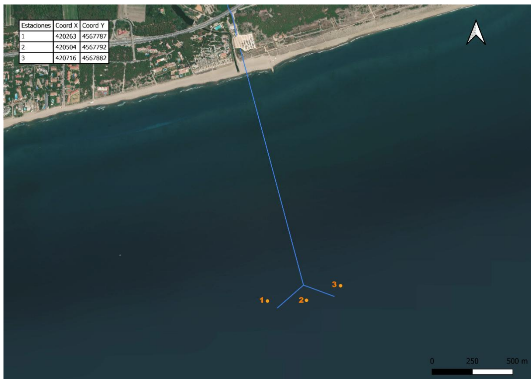
Figura 4. Propuesta de las estaciones de muestreo para el control de vectores, coordenadas en UTM 31 N
