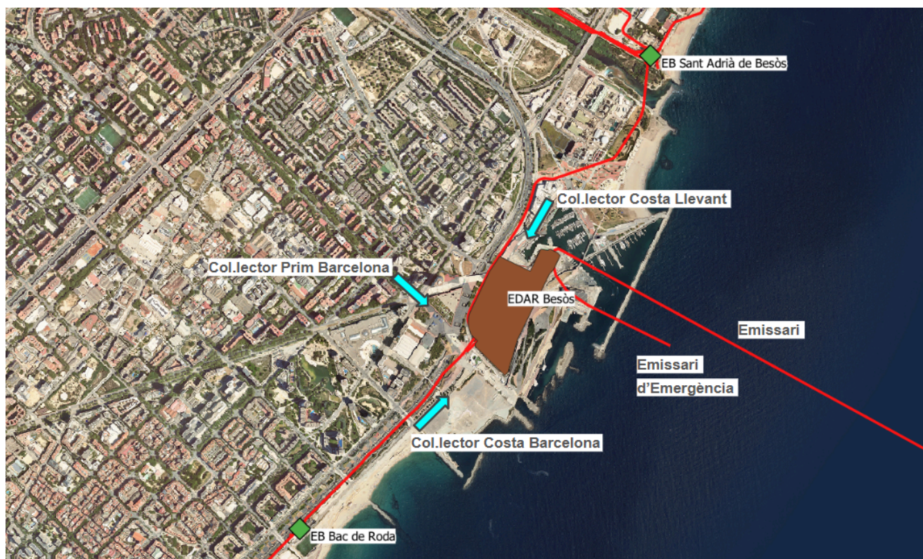
Entradas principales de agua bruta a la EDAR Besós.
