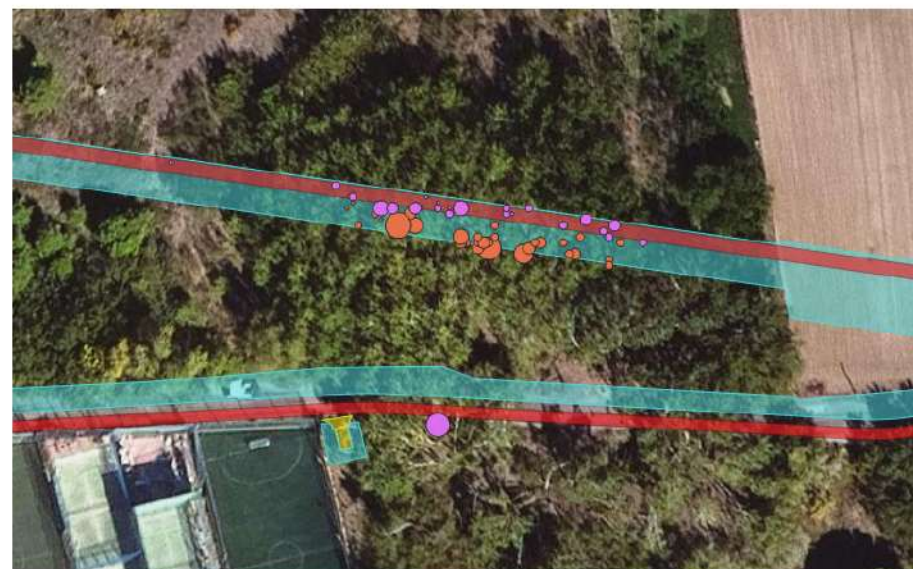
Figura 27. Proposta de tala del tram no solapat del camí de la Pineda. En lila els exemplars que s'han de talar perquè el seu RI coincideix amb la rasa d'excavació (polígon vermell) i en taronja aquells que s'han de talar per seguretat perquè al ser una zona boscosa, serà necessari esbrossar la zona d'ocupació temporal (polígon blau).
