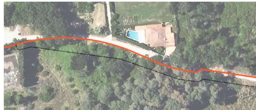
Figura 9. Planta de l'eix principal entre els PK 2+700 i 2+900 on el by-pass s'allunya de l'eix principal per preservar els exemplars arboris que hi ha al marge del camí.
