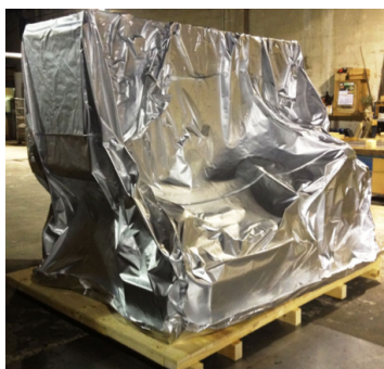
Figura 32. Ejemplo de embalaje marítimo sin caja de madera exterior (mínimo).
