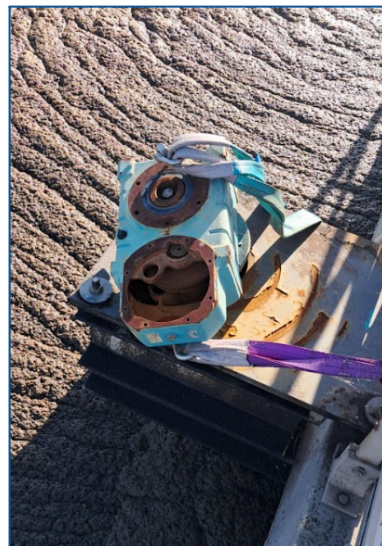
Figura 1. Conjunto motorreductor de algunos de los agitadores de los reactores biológicos a día de hoy
